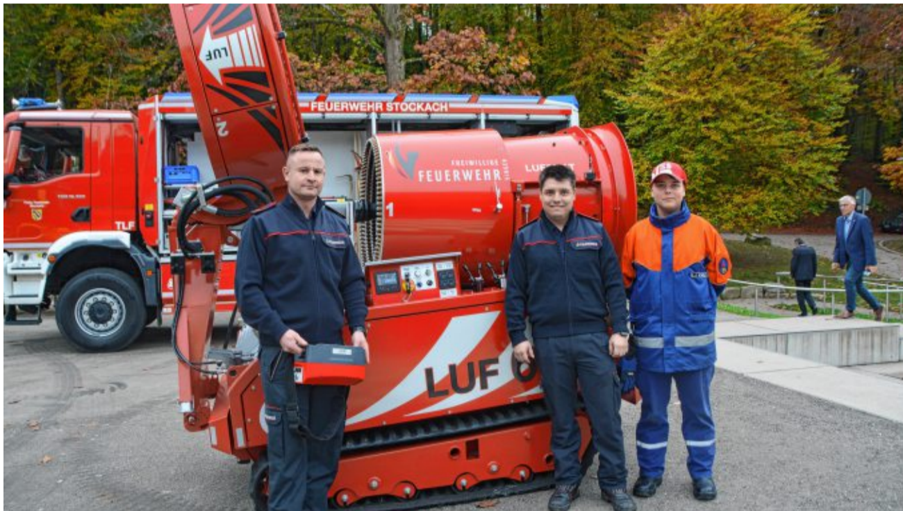
Maximilian Müller, Denis Torre und Luca Schwall (von links) von der Freiwilligen Feuerwehr Singen erklären die Funktionen des ferngesteuerten Löschunterstützungsfahrzeugs (Luf). Der Löschroboter kann dort eingesetzt werden, wo es für Menschen zu gefährlich wird, wie in stark verrauchten Hallen oder Tunneln. BILDER: LORNA KOMM
